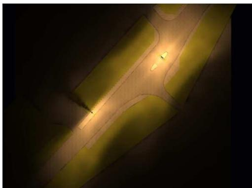
La mise en place d'une tête double assurera un éclairage optimal sur le passage piéton. Le changement du candélabre en face de l'arrêt assurera d'autre part sa signalisation.
