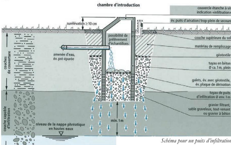
Schéma pour un puits d'infiltration
