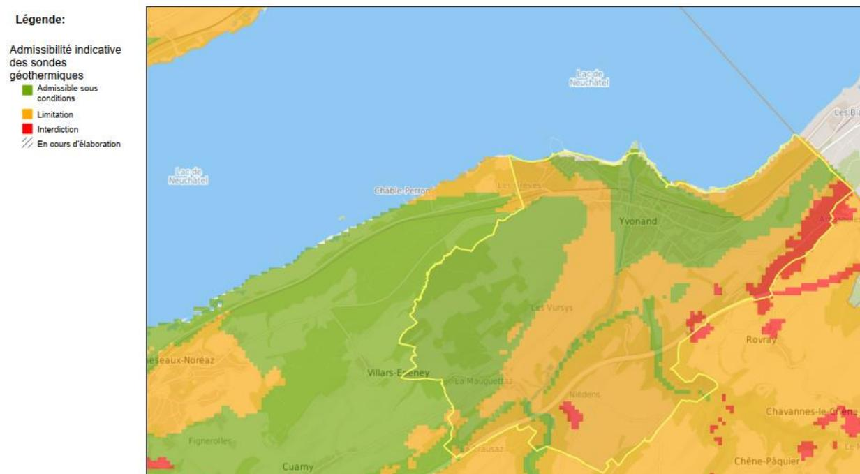
Figure 4 : Admissibilité indicative des sondes géothermiques verticale (source : guichet cartographique cantonal).
